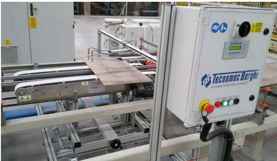
51) GCL 1200/1500 - Girello elettronico a cinghie per grandi formati. 51) GCL 1200/1500 - Electronic tile turner for big size.
