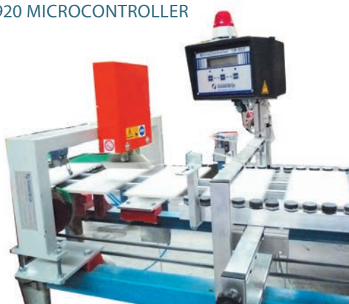
72) TB940 – Controllore della temperatura delle piastrelle. 72) TB940-Temperature tiles controller
